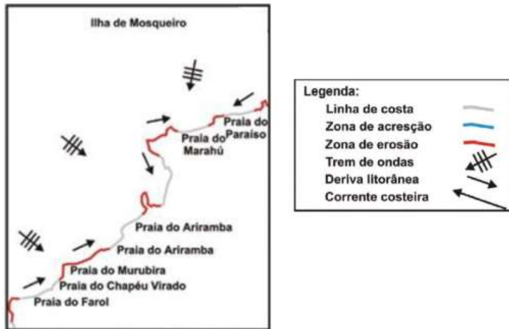
Figura 1 – Células de deriva litorânea proposta para as praias de Mosqueiro com base em observação visual e medida do clima de ondas e na morfologia das feições costeiras.
